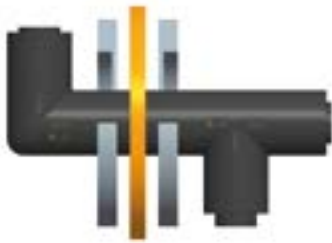
4. Värm upp sammanfogningsytorna
